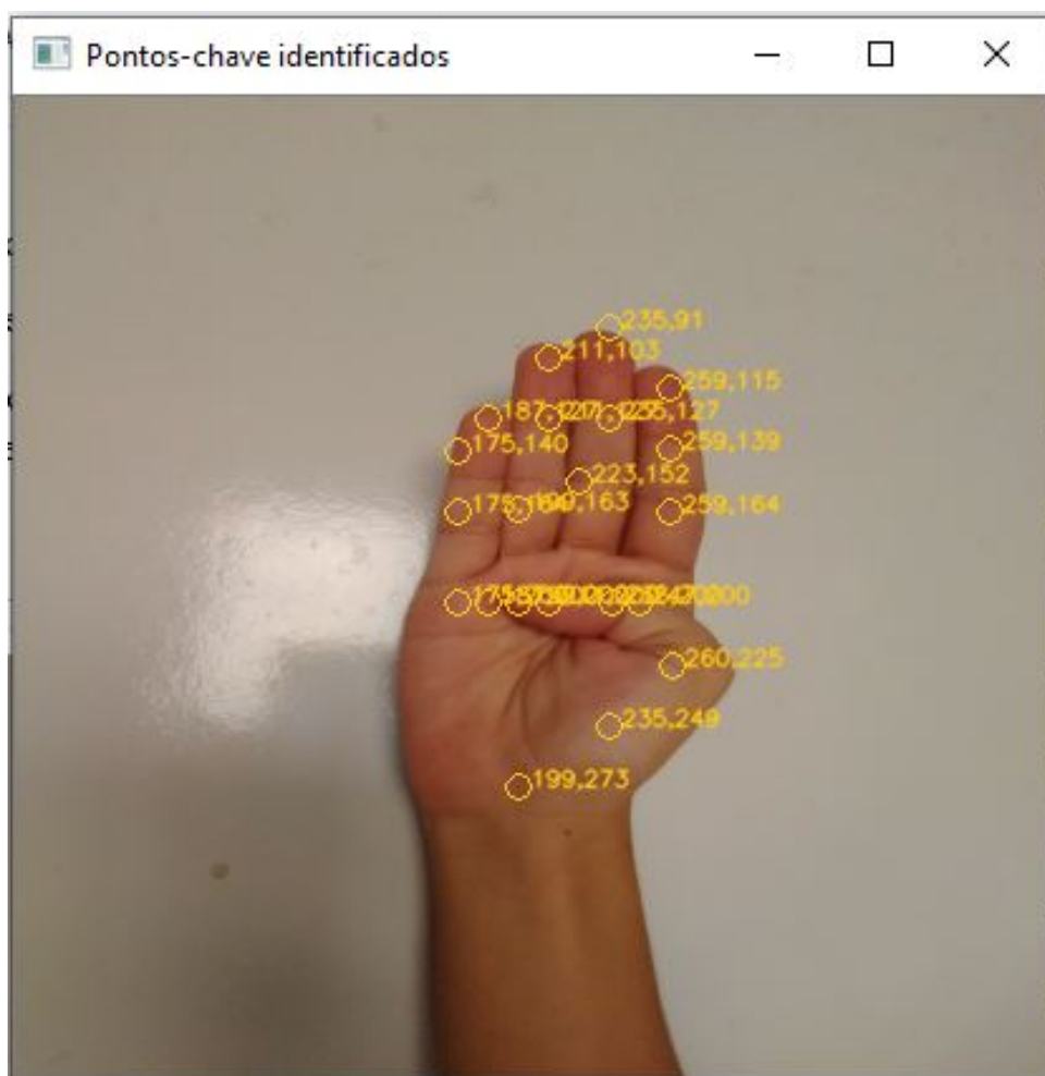
Figura 22 – Mapeamento de key points da mão em configuração do sinal B
