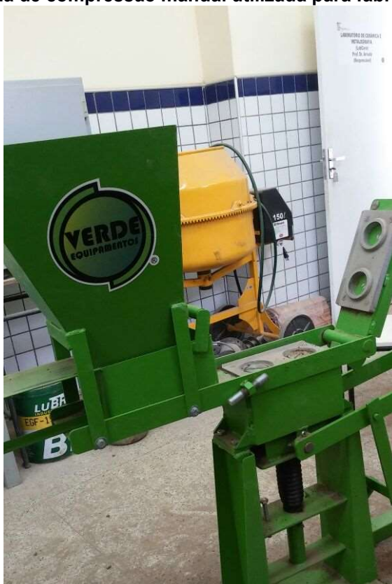
Figura 5 - Máquina de compressão manual utilizada para fabricação dos tijolos.
