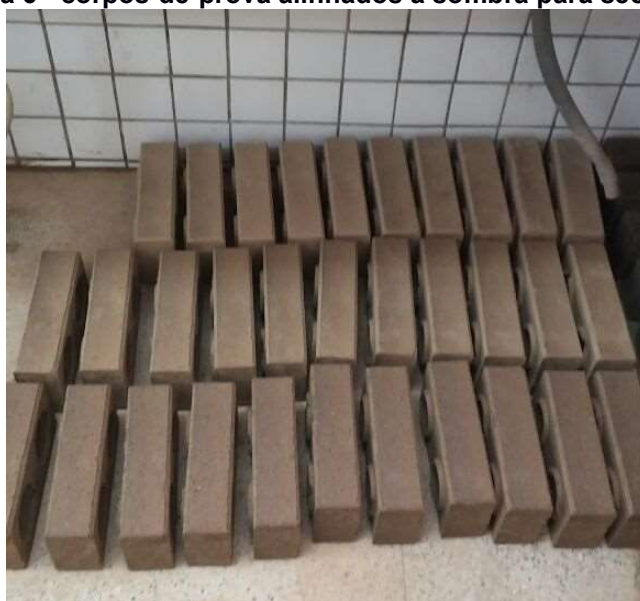
Figura 6 - corpos-de-prova alinhados à sombra para secagem.
