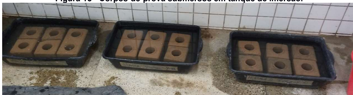
Figura 13 - Corpos-de-prova submersos em tanque de imersão.
