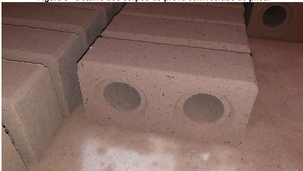
Figura 8 - Detalhe dos corpos-de-prova com resíduo de pneu.
