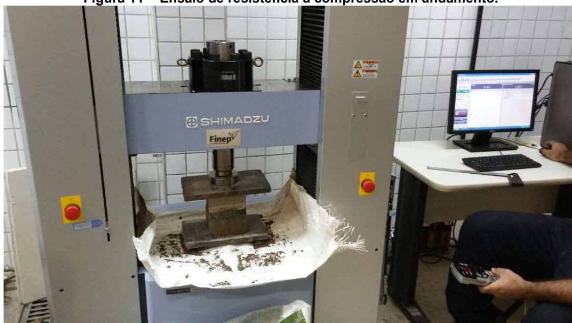
Figura 11 - Ensaio de resistência à compressão em andamento.
