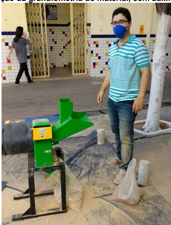
Figura 3- Redução da granulometria do material, com auxílio de forrageiro.
