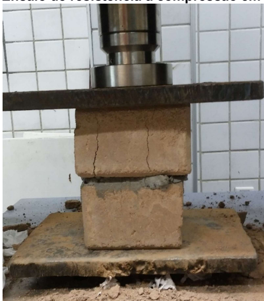
Figura 12 - Ensaio de resistência à compressão em andamento.
