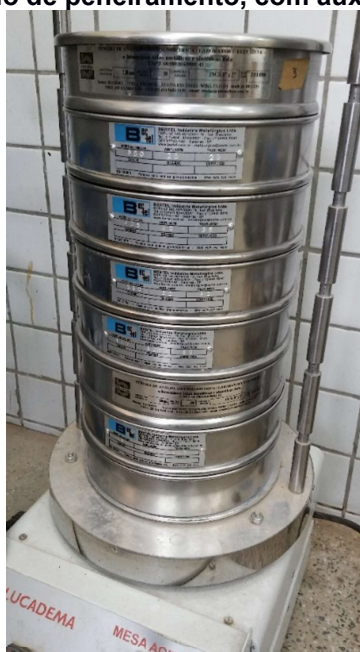
Figura 4- Realização do ensaio de peneiramento, com auxílio da mesa vibratória.
