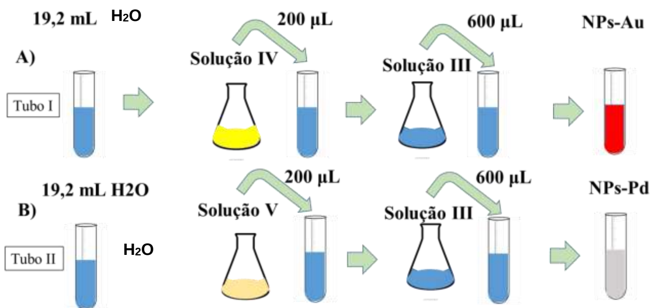
Figura 10 - Esquema ilustrativo apresentando as etapas de síntese empregadas nas sínteses (NPs-Au) A e (NPs-Pd) B.
