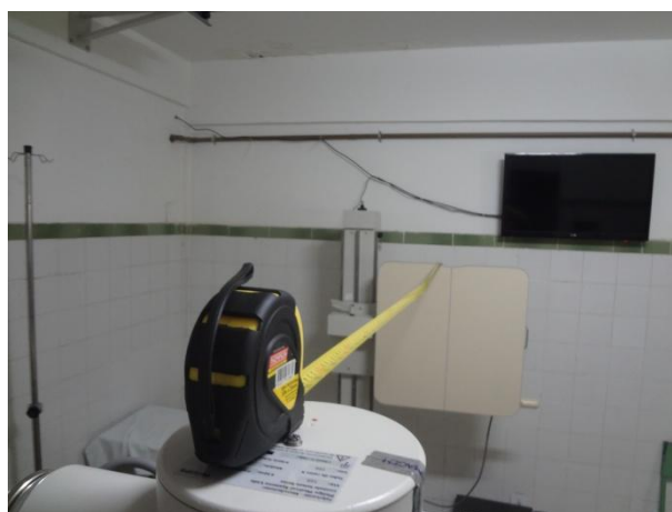
Figura 4 – Mensuração da distância foco-filme usando uma trena.
