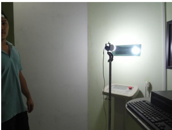
Figura 6 - lâmpada posicionada e acionada para análise do campo de visão.
