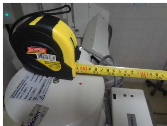
Figura 3 – Ajuste da distancia entre o bucky vertical e o ponto focal em 1,80 metros.
