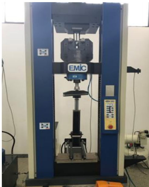
Figura 5.2-Máquina EMIC DL20000 no laboratório de ensaios mecânicos da universidade federal do Piauí
