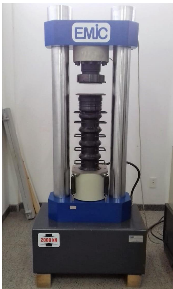
Figura 28 – Equipamento utilizado no ensaio de resistência à compressão dos adoquins
