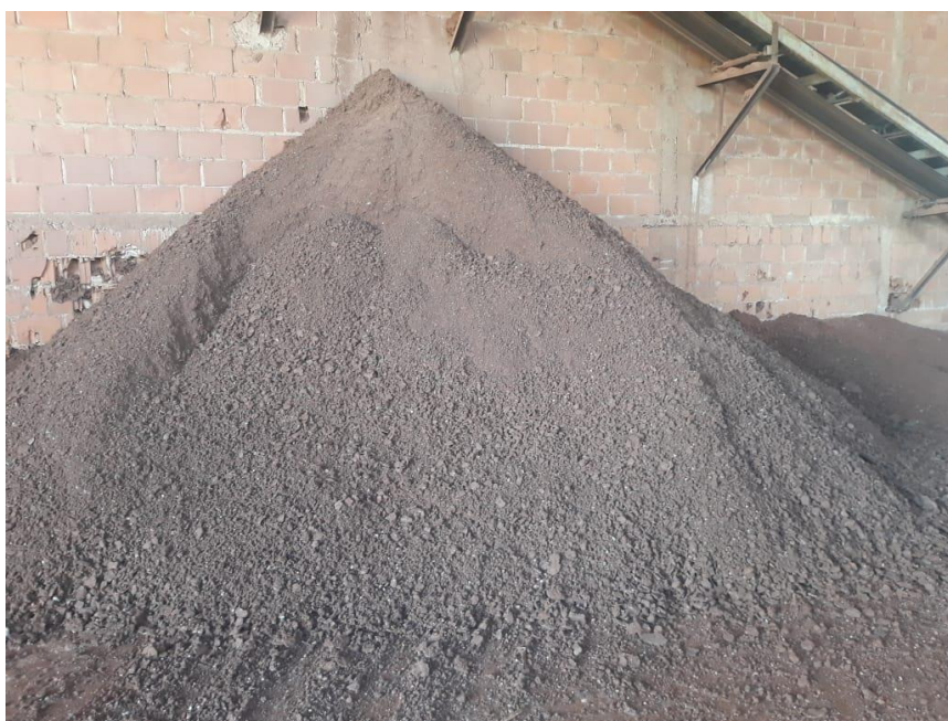
Figura 11 – Massa argilosa da indústria cerâmica
