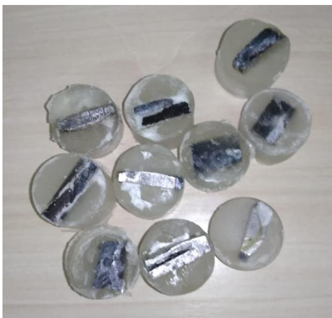
Figura 22– Embutimento de amostras
