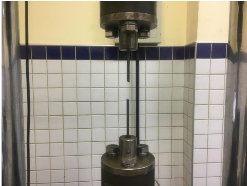
Figura 24 – Vergalhão de aço CA-60 em formato de barra isolada após ensaio de fadiga
