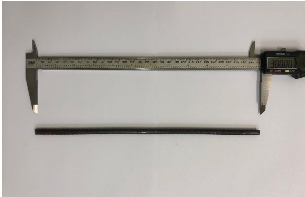
Figura 11 – Vergalhão de aço CA-60 com diâmetro nominal de 7 mm e 30 cm de comprimento
