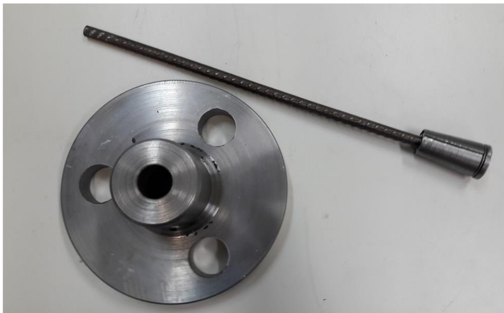
Figura 6 – Mordente composto por fixador cônico e cunha com semi-canas de alumínio
