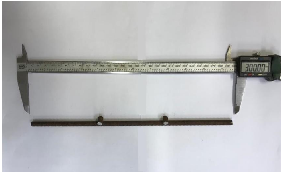
Figura 12 – Vergalhão de aço CA-60 com diâmetro nominal de 7 mm e 30 cm de comprimento retirado de uma tela soldada com espaçamento de 10 cm entre barras
