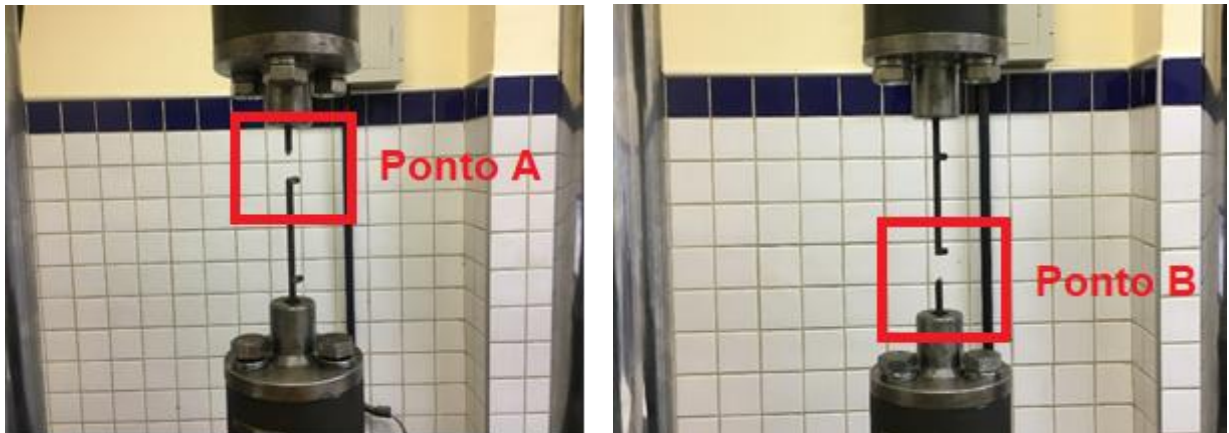
Figura 25 – Vergalhões de aço CA-60 em formato de tela soldada após ensaio de fadiga. (a) Ponto A (solda de cima) de ruptura; (b) Ponto B (solda de baixo) de ruptura
