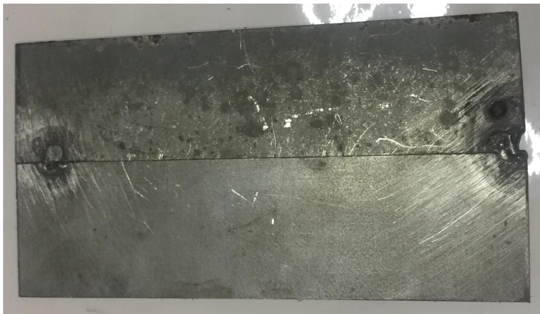
Figura 5. Chapas com ponto de solda.
