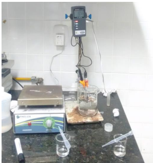
Figura 6 – Determinação do pH com uso do pHmetro de bancada.
