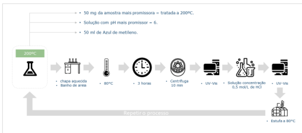
Figura 10 - Procedimento do ensaio de dessorção.
