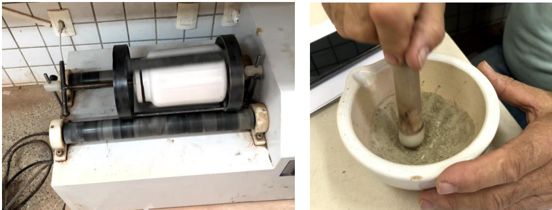
Figura 4 - Argila sendo moída no moinho de bolas e manualmente para o processo de intercalação.
