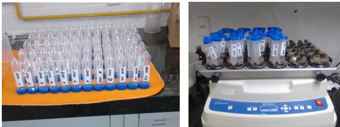
Figura 8 – Tubos falcon submetidos à agitação por uma mesa agitadora.
