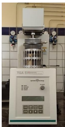
Figura 13 - Aparelho utilizado na análise térmica por TG
