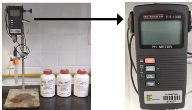
Figura 18 - pHmetro utilizado na determinação do pH em água e SBF
