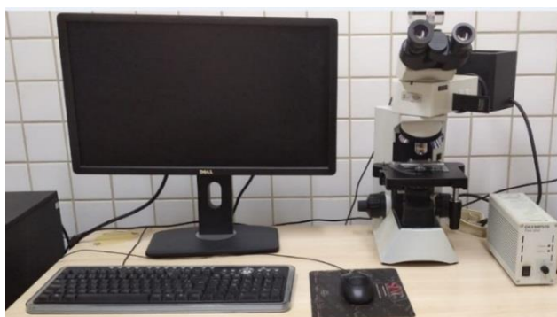
Figura 11 - Aparelho utilizado na análise de microscopia óptica
