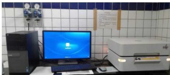
Figura 12 - Aparelho utilizado na análise de Florescência de Raios - X
