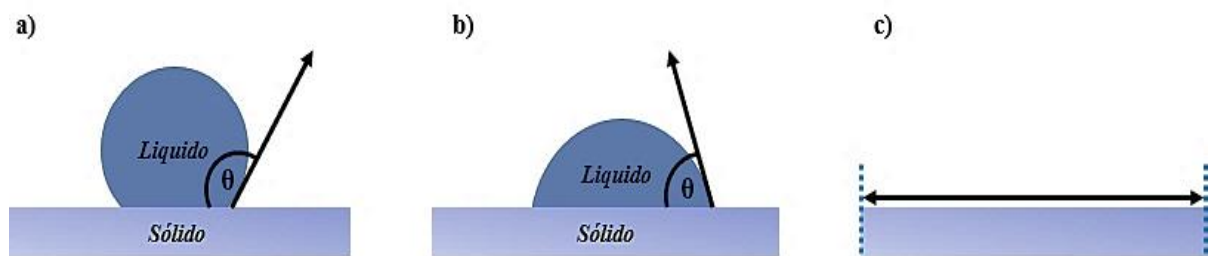
Figura 17 - Representação do ângulo de contato (a) maior do que 90^\circ , (b) menor do que 90^\circ e (c) espalhamento total.
