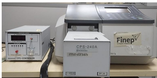
Figura 15 - Aparelho utilizado na análise de absorção na região do Ultravioleta/Visível
