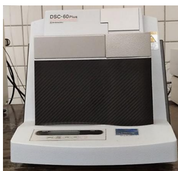
Figura 14 - Aparelho utilizado na análise térmica por DSC
