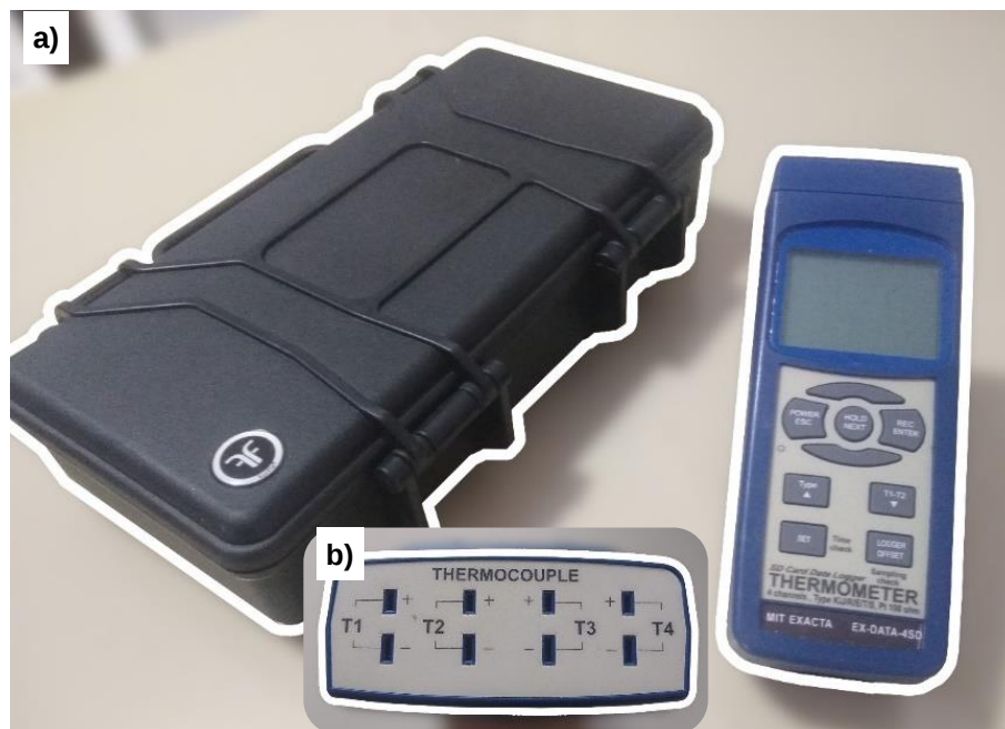
Figura 32 – Data logger de 04 canais para termopares
