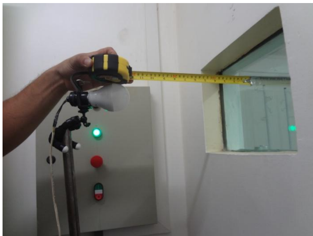
Figura 5 - Posicionando a lâmpada a 30 cm do centro do visor plumbífero.
