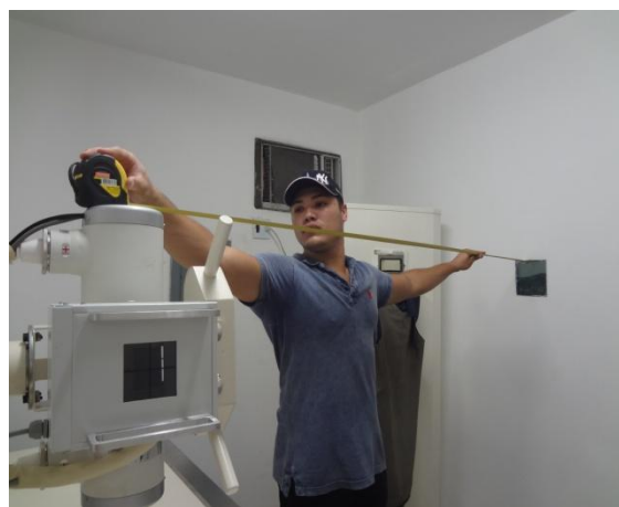
Figura 9 – Pesquisador realizando medida da distância entre o visor plumbífero e ponto focal.
