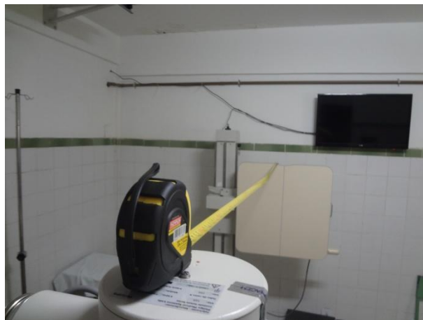
Figura 4 – Mensuração da distância foco-filme usando uma trena.
