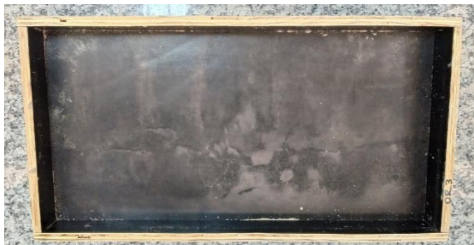
Figura 28 – Estado da superfície da forma após aplicação do OR.
