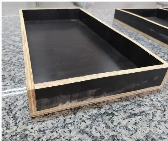
Figura 10: Molde de madeira plastificada 25x50x5cm
