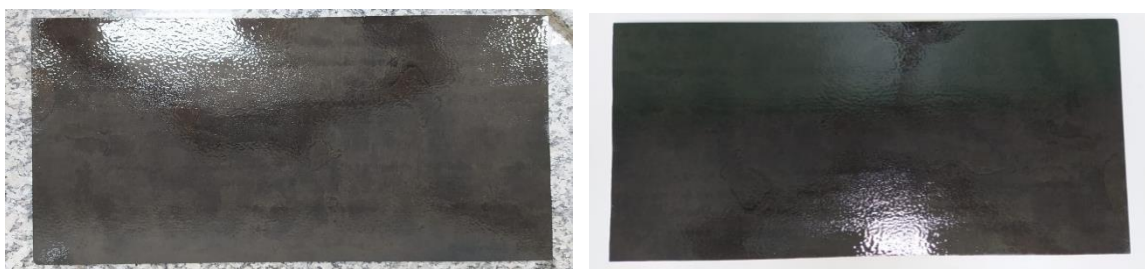
Figura 20 – Estado da superfície da forma após espalhamento do OB com rolo
