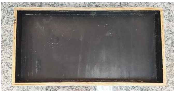
Figura 27 – Estado da superfície da forma após aplicação do OB.
