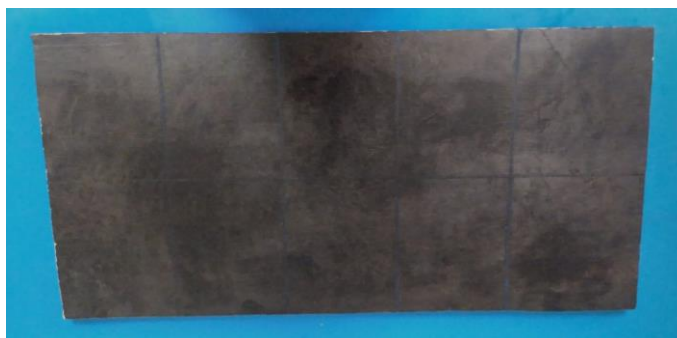
Figura 23 – Estado da superfície da forma após o gotejamento do óleo mineral (OM)
