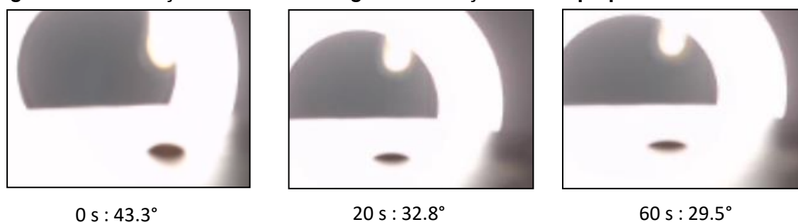
Figura 17 – Evolução do formato da gota em função do tempo para a amostra de OR.
