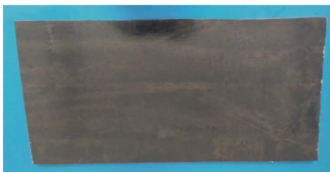
Figura 22 – Estado da superfície da forma após o gotejamento do óleo residual (OR)
