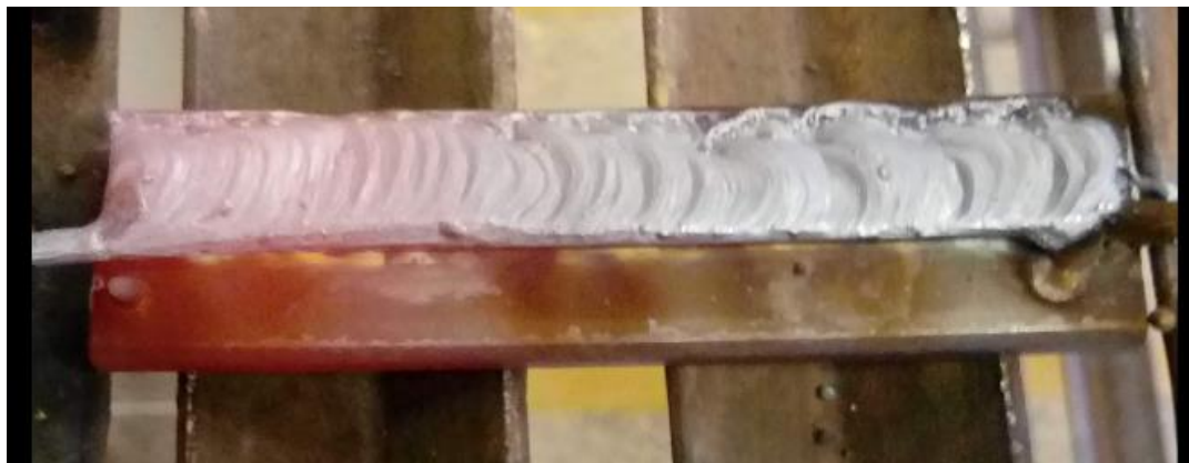
Figura 10: Corpo de prova de ensaio de tração (AT10). Execução do primeiro passe de soldagem sobre o metal base e fios de reforço.
