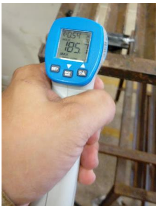
Figura 07: Monitoramento da temperatura de pré-aquecimento.
