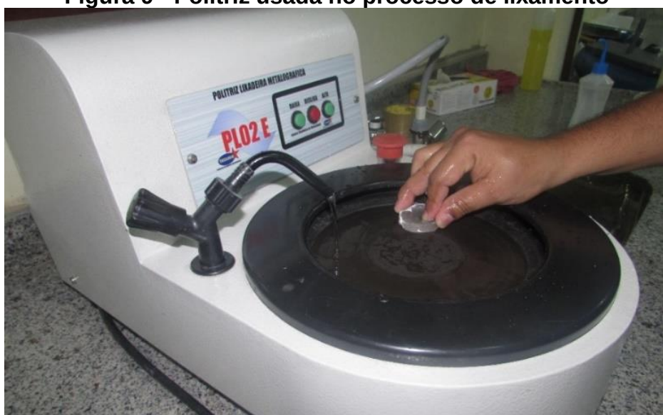
Figura 9 - Politriz usada no processo de lixamento
