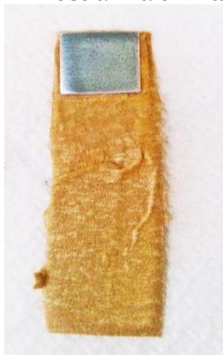
Figura 8 - Amostra fixa em fita adesiva
