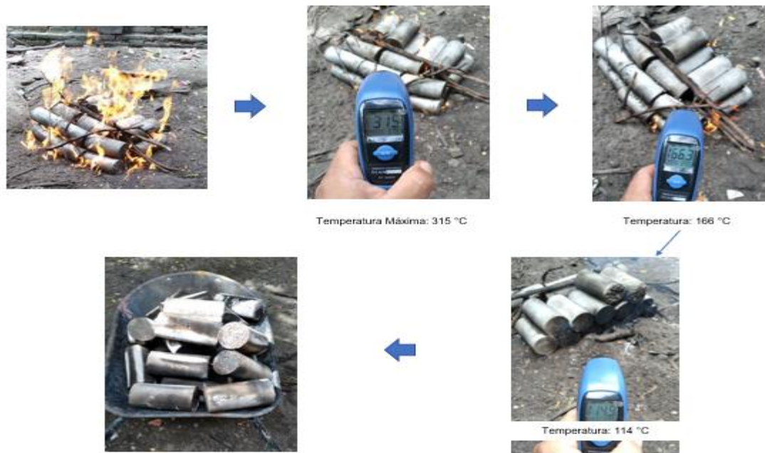
Figura 38 – Etapas da simulação de incêndio através da utilização de gasolina
