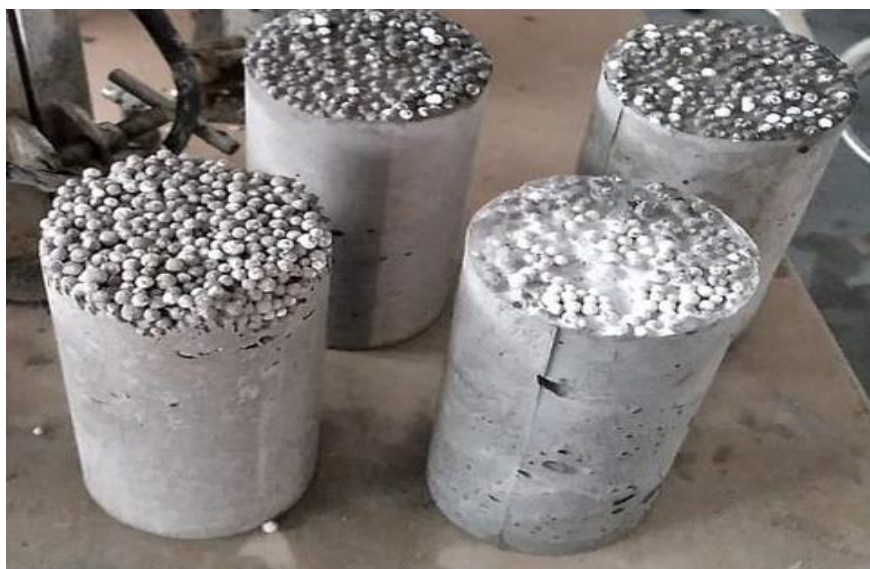
Figura 33 – Corpos de prova - Concreto Leve
