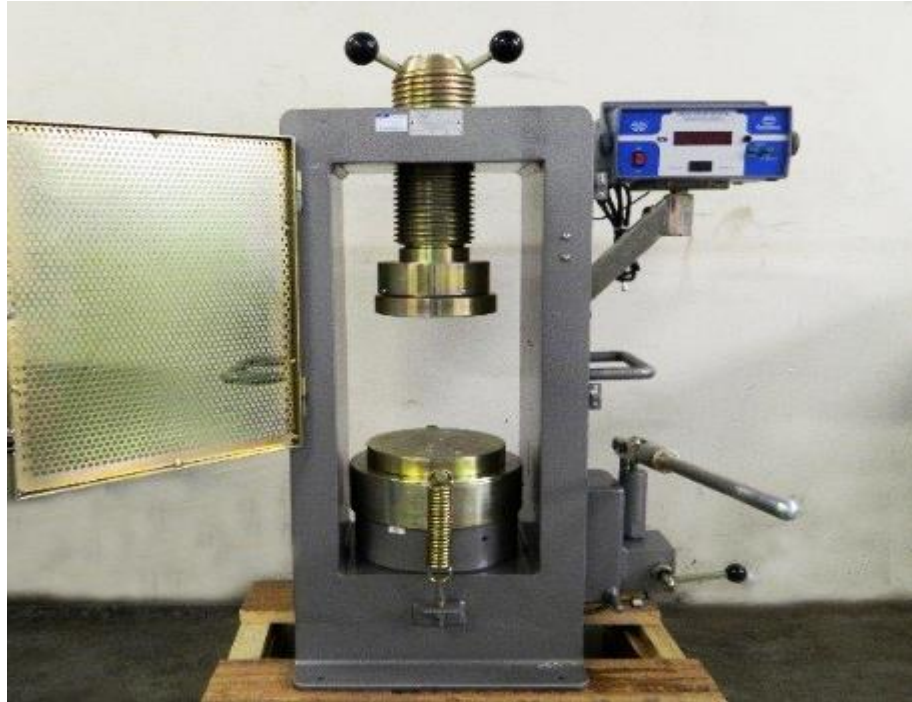
Figura 39 – Prensa Manual para Ensaios de Concreto - Contenco
