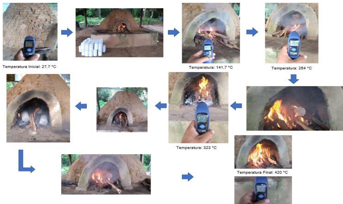
Figura 36 – Etapas da simulação de incêndio no forno cerâmico caseiro
