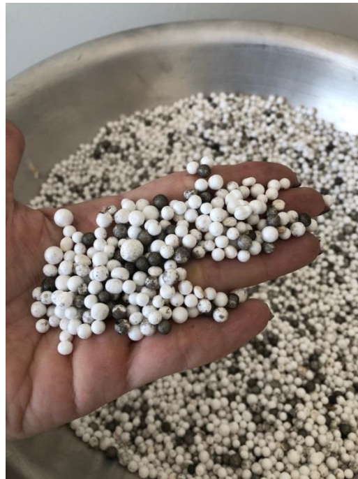
Figura 29 – Preparação das pérolas de EPS para realização de gráfico da distribuição granulométrica
