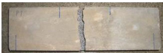
Figura 27 – Laje de concreto leve com EPS
