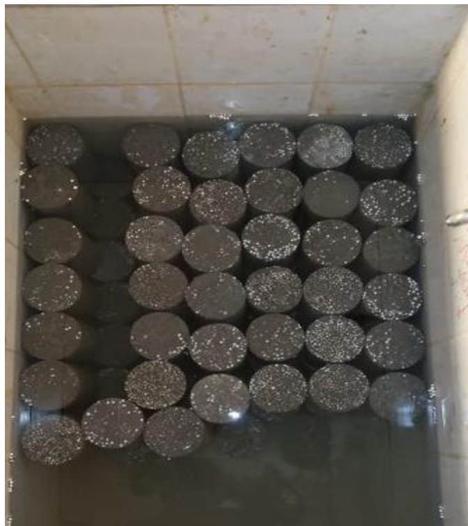
Figura 34 – Corpos de Prova acondicionados em tanques com água potável para cura
