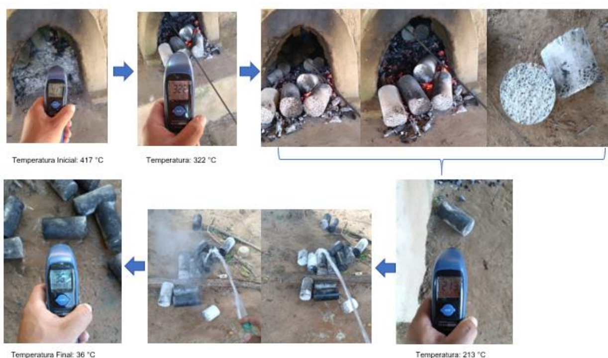
Figura 37 – Processo de resfriamento dos corpos de prova após simulação de incêndio em forno cerâmico caseiro
