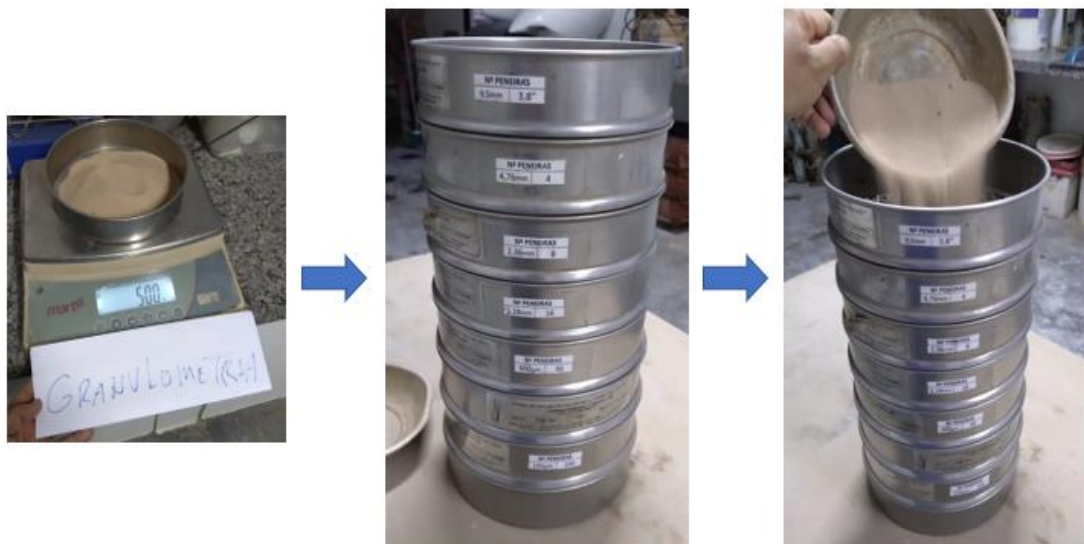
Figura 30 – Determinação da composição granulométrica da areia
