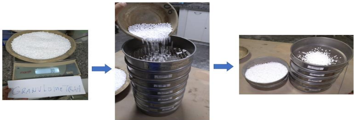
Figura 31 – Determinação da composição granulométrica do EPS
