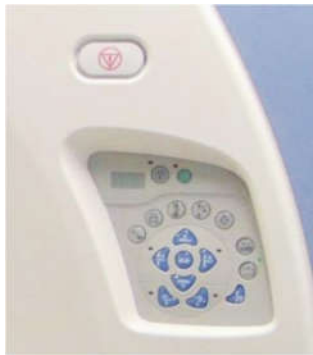
Figura 2: Painel de controle do Gantry
