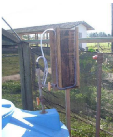
Figura 4: Experimento para determinação da pressão no biodigestor.
