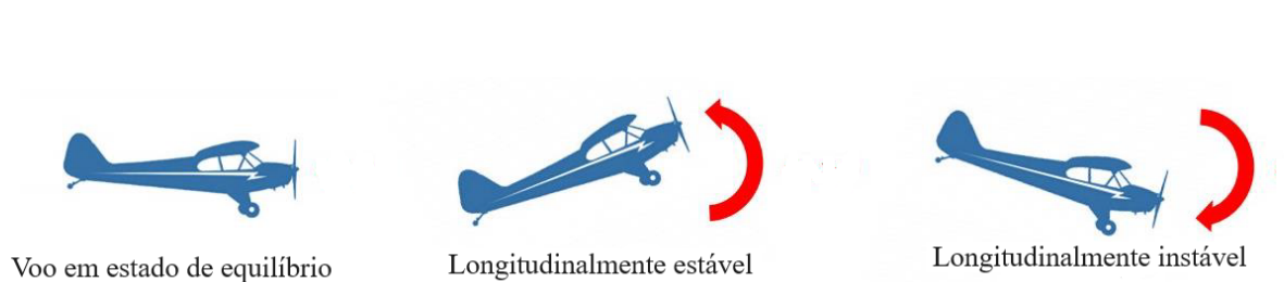
Figura 13 – Comportamento longitudinal de uma aeronave.
