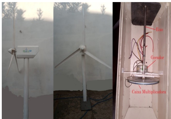
Figura 3 - Aerogerador e estrutura interna.
