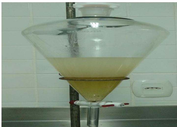
Figura 8: Composto óleo-reagente em etapa de separação de fases.
