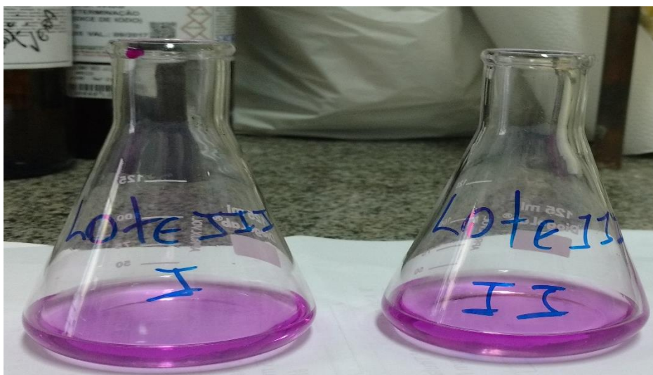
Figura 10: Final da titulação de amostra para determinação de índice de acidez.
