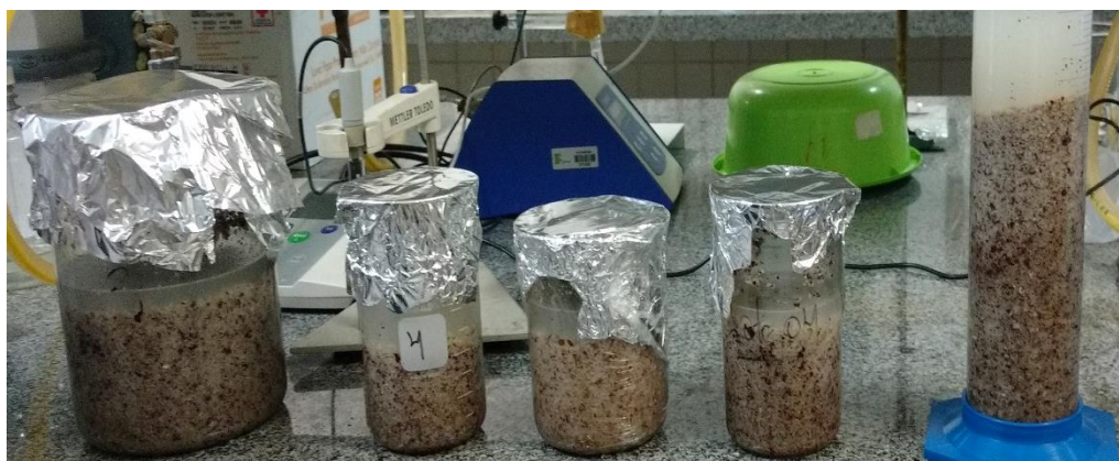
Figura 7: Amostras de farelo de coco submetidas à extração à frio (Bligh & Dyer).
