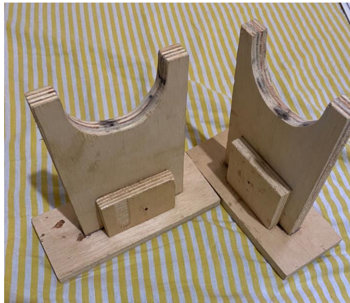
Figura 8: Base de suporte para o tubo.
