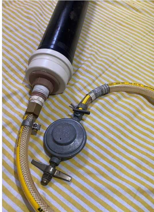
Figura 11: Mangueira de gás e registro adaptada ao nível.
