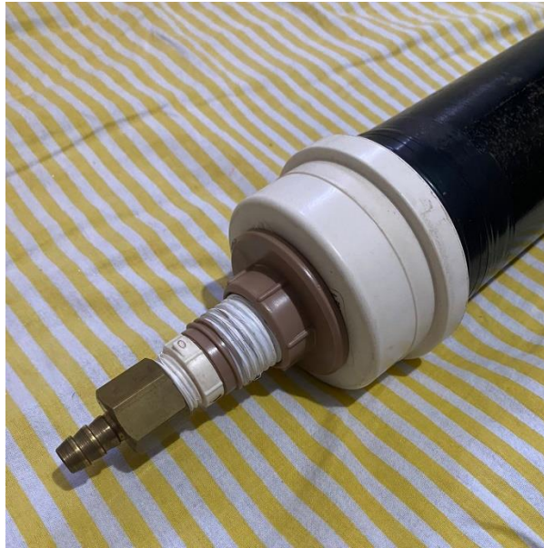
Figura 9: Adaptação do Cap, flange e nípel.
