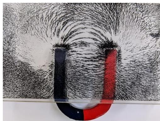
Figura 2 – Campo gerado por um ímã em forma de ferradura
