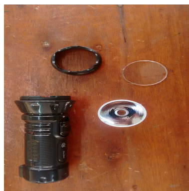
Figura 20 – Lanterna desmontada. O espelho esférico garante que o feixe luminoso formado seja propagado numa direção paralela ao seu eixo.
