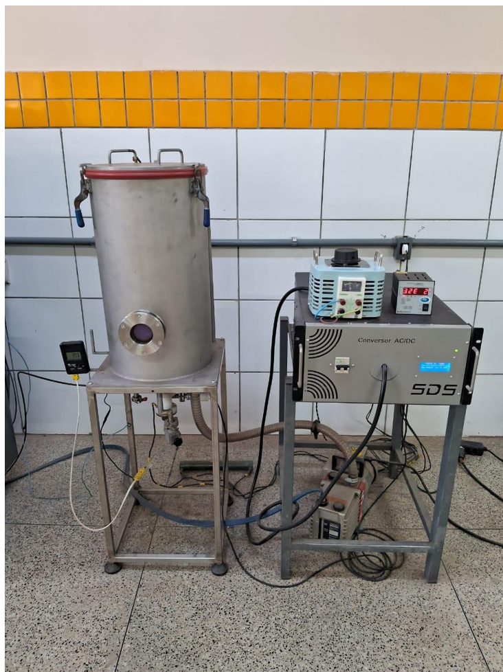
Figura 7: Imagem do reator de tratamento a plasma do LabPlasma – UFPI.
