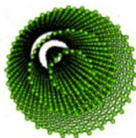
Figura 2.11: Representação esquemática de um nanotubo de carbono de paredes múltiplas. Fonte: http://biomedica-univap-uespi.blogspot.com.br/2016/01/francilio-decarvalho-oliveira.html .
