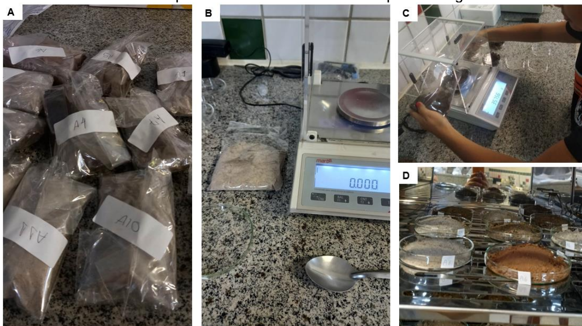
Figura 8 – Coleta dos parâmetros ambientais. A – Material coletado. B – Material utilizado para pesagem das amostras do solo. C – Pesagem das amostras. D – Amostras posicionadas dentro da estufa para secagem
