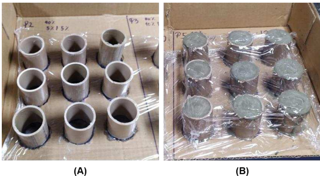
Figura 10 – Moldes confeccionados em canos PVC (A) e corpos-de-prova moldados (B).
