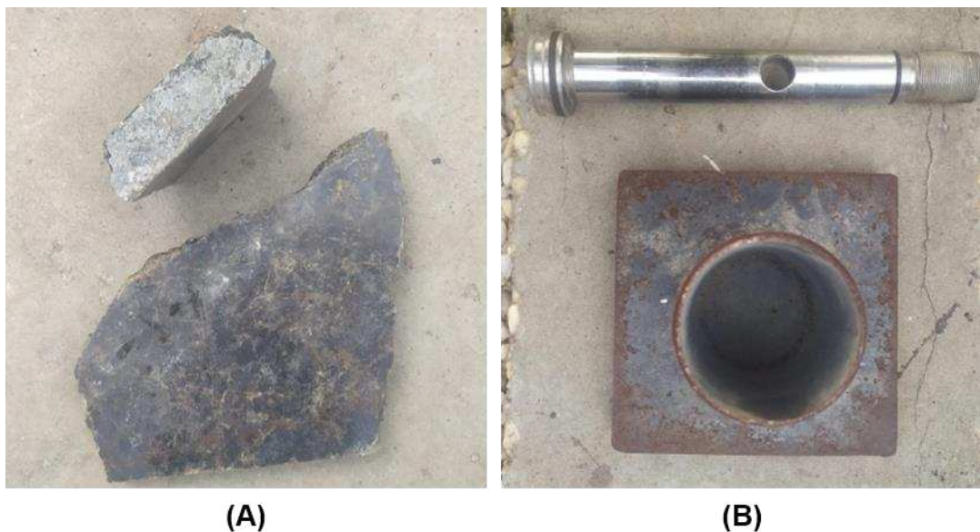
Figura 8 – Peças defeituosas (A) e ferramentas utilizadas para trituração (B).
