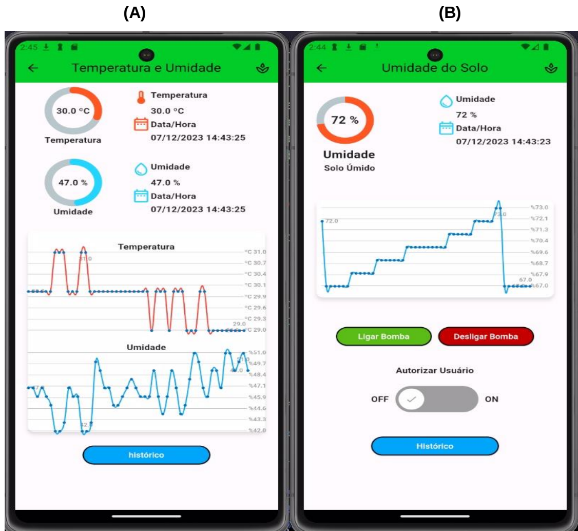
Figura 4 - (A) Dados da temperatura e umidade do ar. (B) Dados da umidade do solo.
