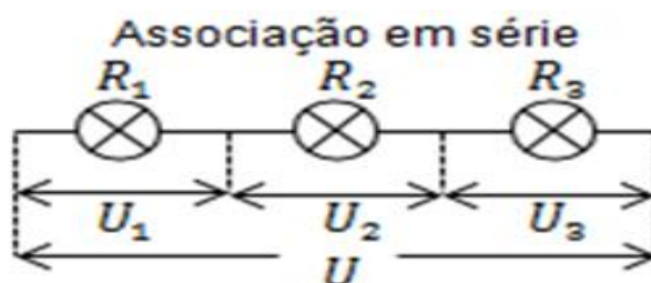
Figura – 3 lâmpadas em série ficam submetidas à mesma corrente elétrica.
