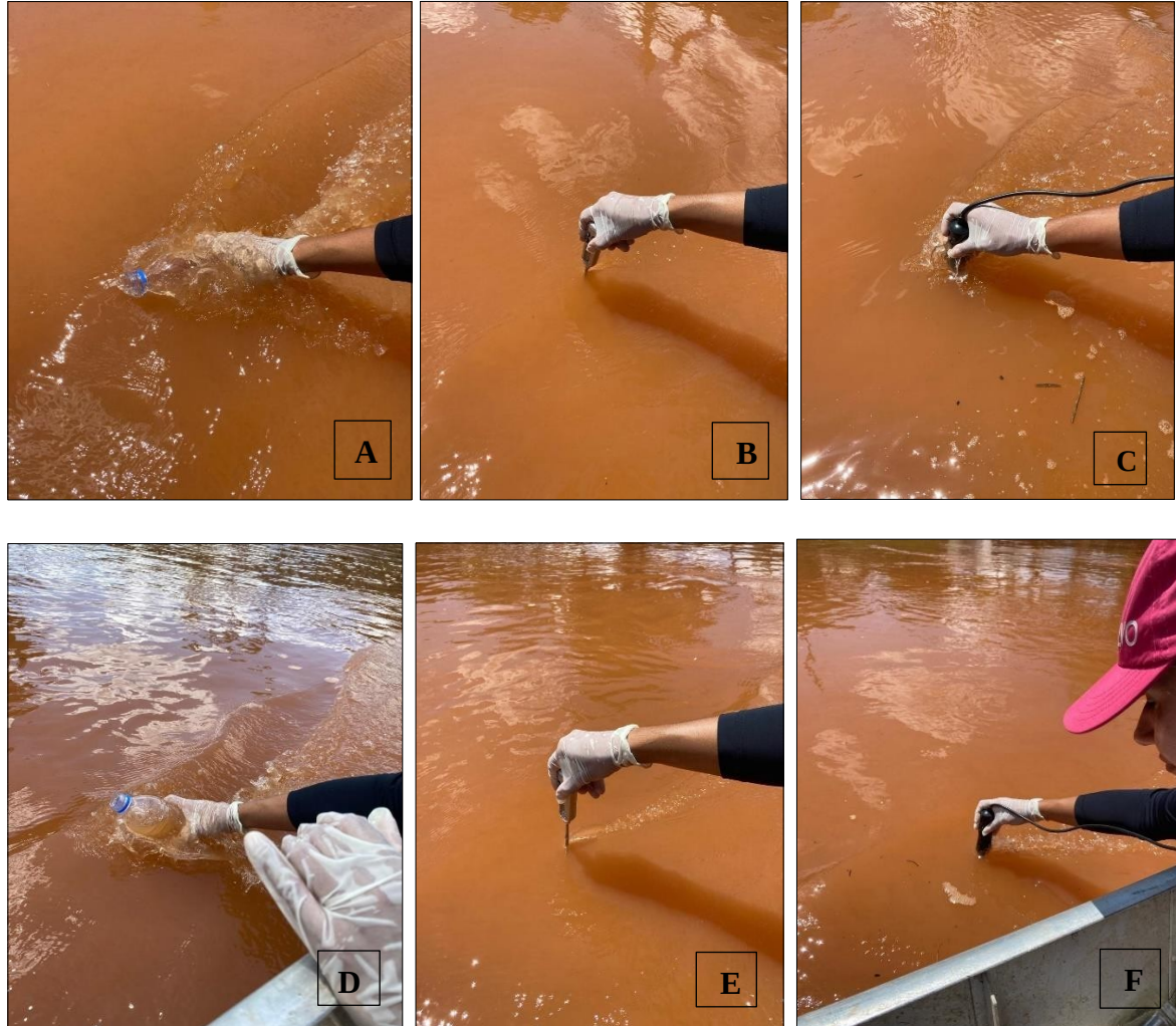
Figura 2 - Coleta no Período Chuvoso - Ponto de coleta 1 –Montante (A) próximo ao perímetro da ponte do rio; (B) medição de temperatura; (C) oxigênio dissolvido; Ponto 2 - Eixo do Rio (D) ; (E) medição de temperatura e (F) oxigênio dissolvido. Fonte: Autora, (2024).
