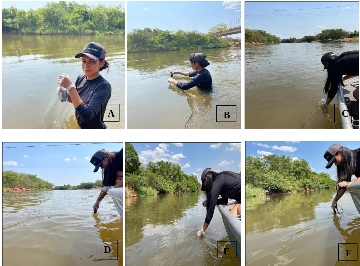
Figura 1- Coleta no Período Seco: Ponto de coleta 1 – Montante (A) próximo ao perímetro da ponte do rio; (B) aferição do Oxigênio dissolvido; (C) Ponto 2 - Eixo do Rio; (D) aferição de oxigênio dissolvido; (E) Ponto 3- Jusante; (F) aferição de oxigênio dissolvido. Fonte: Autora, 2022
