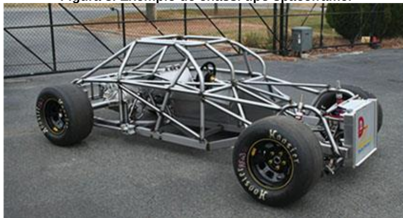
Figura 3. Exemplo de chassi tipo spaceframe.
