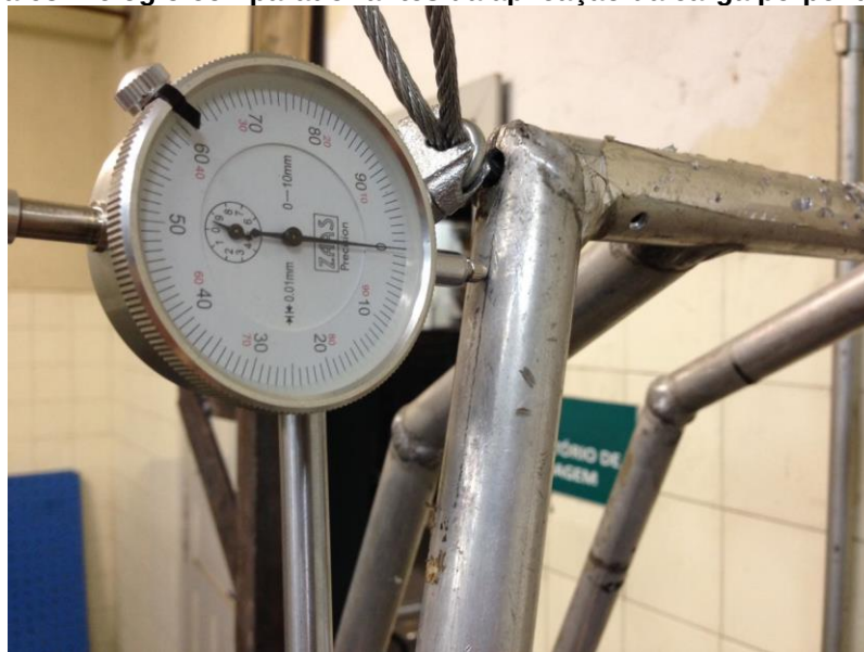
Figura 63. Relógio comparador antes da aplicação da carga perpendicular
