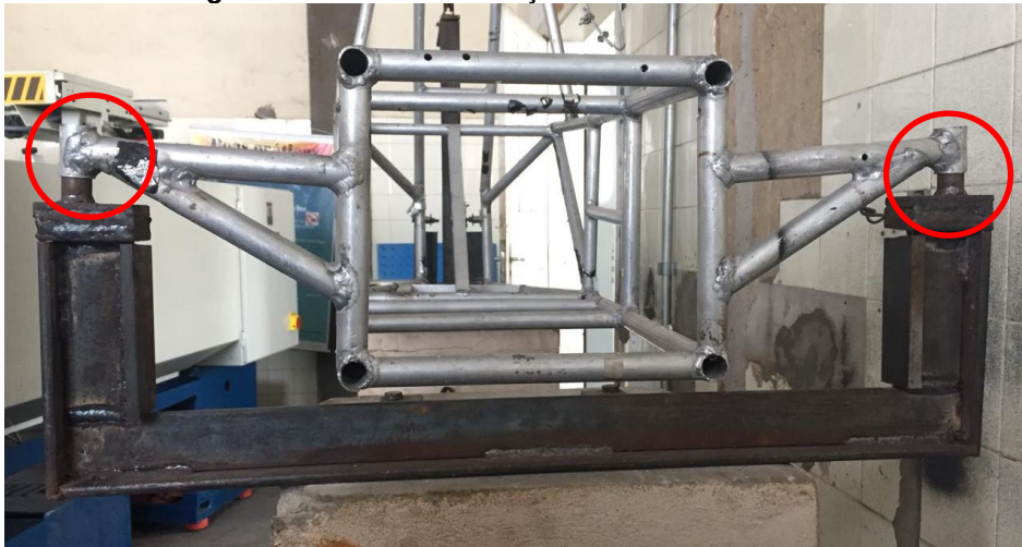
Figura 53. Pontos de fixação dianteiro do chassi.
