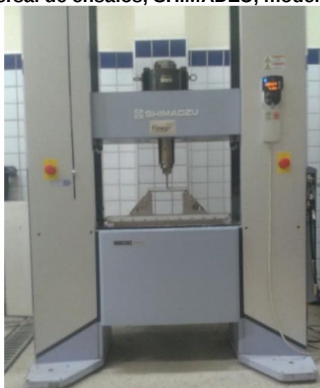
Figura 68. Máquina universal de ensaios, SHIMADZU, modelo Autograph AG-X 300kN.
