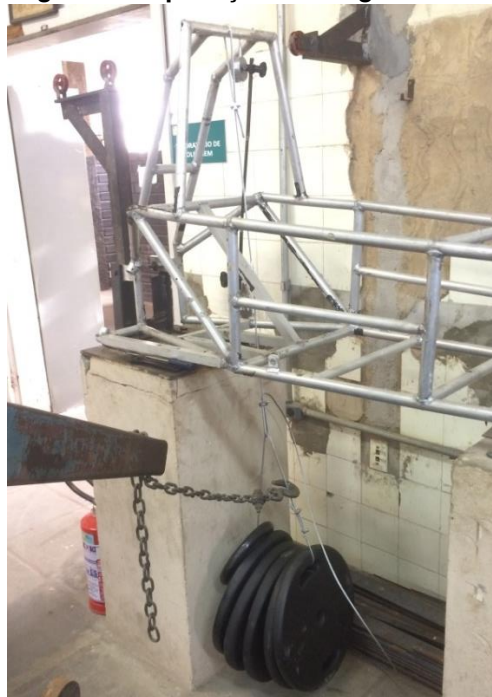
Figura 58. Aplicação da carga vertical.
