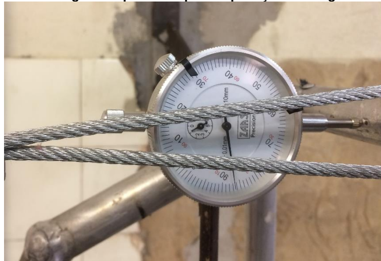
Figura 62. Relógio comparador após a aplicação da carga horizontal.
