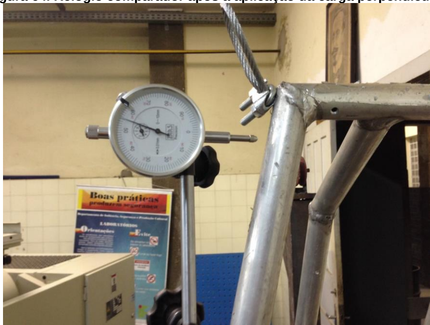
Figura 64. Relógio comparador após a aplicação da carga perpendicular.
