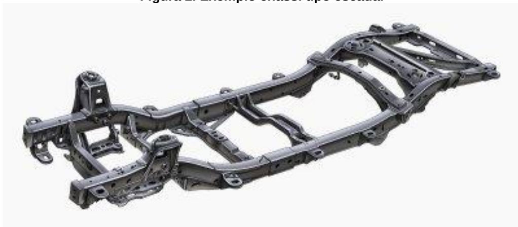
Figura 2. Exemplo chassi tipo escada.
