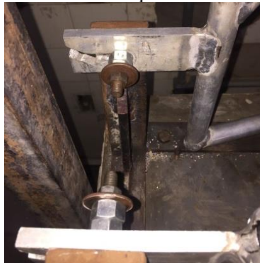
Figura 54. Pontos de fixação dianteiro do chassi.
