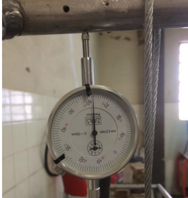
Figura 59. Relógio comparador após a aplicação da carga vertical.
