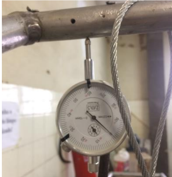
Figura 57. Relógio comparador antes da aplicação da carga vertical.
