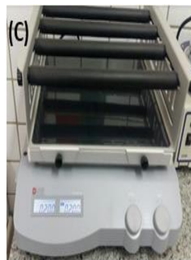
Figura 6 - Equipamentos utilizados para a obtenção dos extratos da cebola roxa: (A) Estufa; (B) Balança analítica; (C) Mesa Agitadora Orbital; (D) ultrassom; (E) Banho - Maria.
