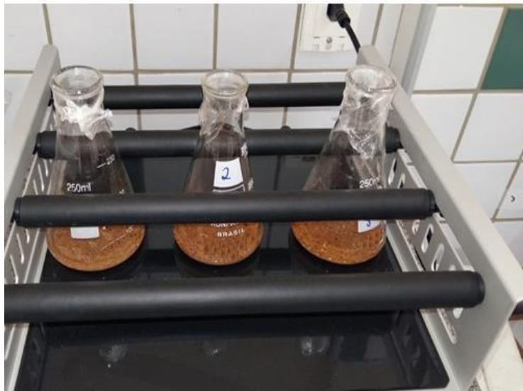
Figura 10 - Obtenção dos extratos metanólicos.
