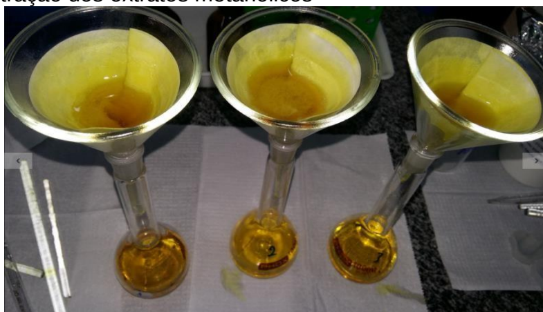
Figura 11 - Filtração dos extratos metanólicos
