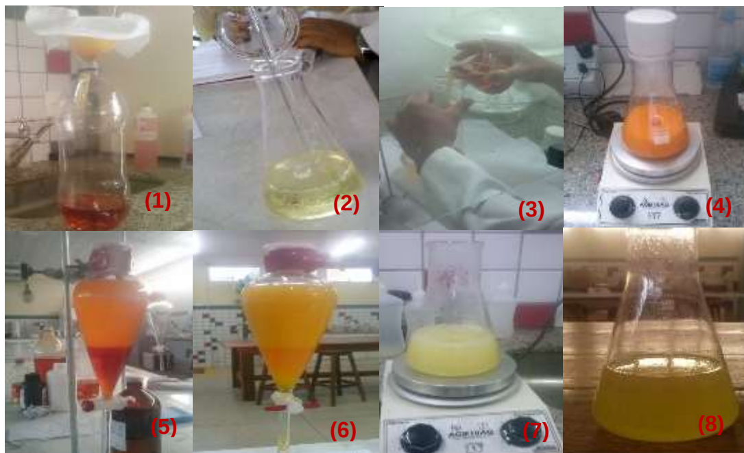
Figura 6 – Etapas do processo de obtenção do Biodiesel do óleo de fritura: (1) pré-tratamento óleo de fritura; (2) preparação da solução de hidróxido de sódio-metanol; (3) adição da solução de hidróxido de sódio-metanol ao óleo de fritura previamente filtrado; (4) início da reação; (5) separação das fases: biodiesel (superior) e glicerol (inferior); (6) lavagem; (7) secagem; (8) produto final (biodiesel).
