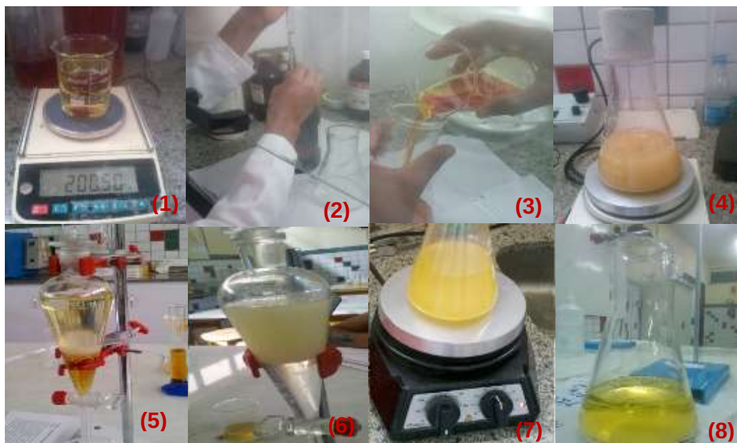
Figura 7 – Etapas do processo de obtenção do Biodiesel do óleo de soja: (1) preparação e pesagem do óleo; (2) preparação da solução de hidróxido de sódio-metanol; (3) adição da solução de hidróxido de sódio-metanol ao óleo de soja; (4) início da reação; (5) separação das fases: biodiesel (superior) e glicerol (inferior); (6) lavagem; (7) secagem; (8) produto final (biodiesel).
