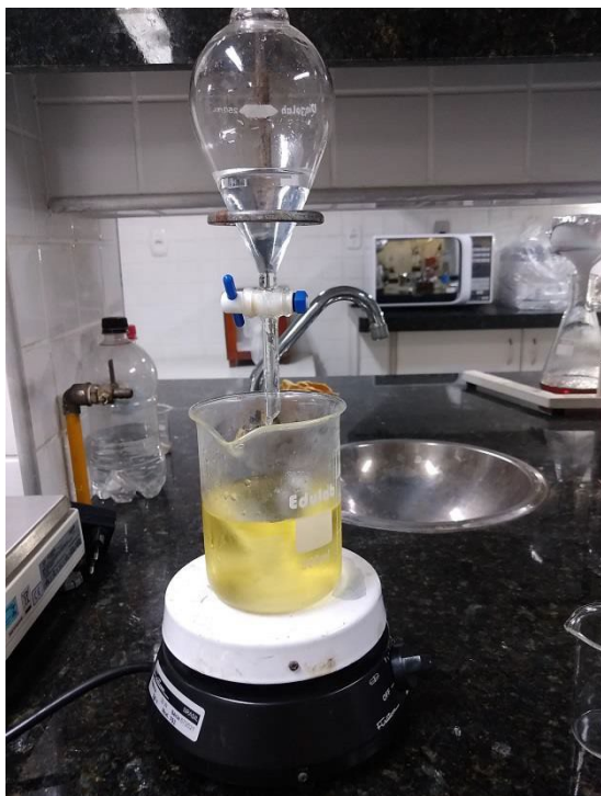
Figura 6 – Processo de síntese das nanopartículas de prata (AgNPs).
