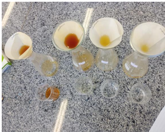
Figura 07: Amostras sendo filtradas para determinação de sólidos insolúveis
