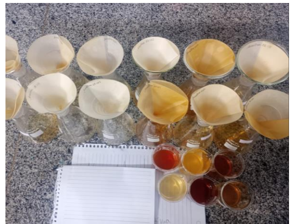
Figura 08: Amostras sendo filtradas para determinação de sólidos insolúveis
