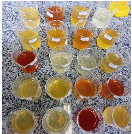
Figura 10: Reação do mel com tintura de iodo 2%
