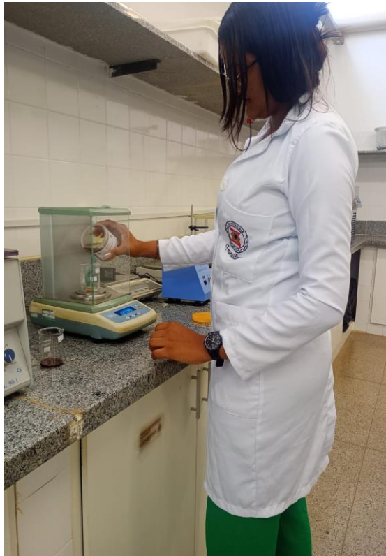
Figura 05: Pesagem de amostra para análise de sólidos insolúveis
