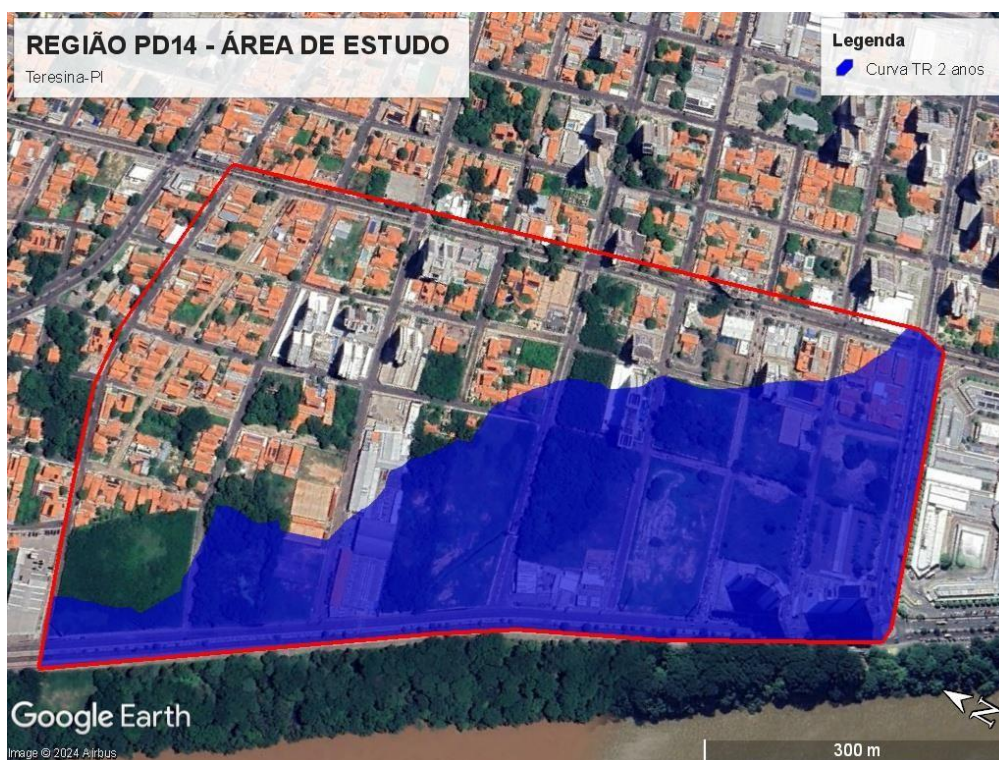
Figura 35 - Mancha de inundação - Tr = 2 anos
