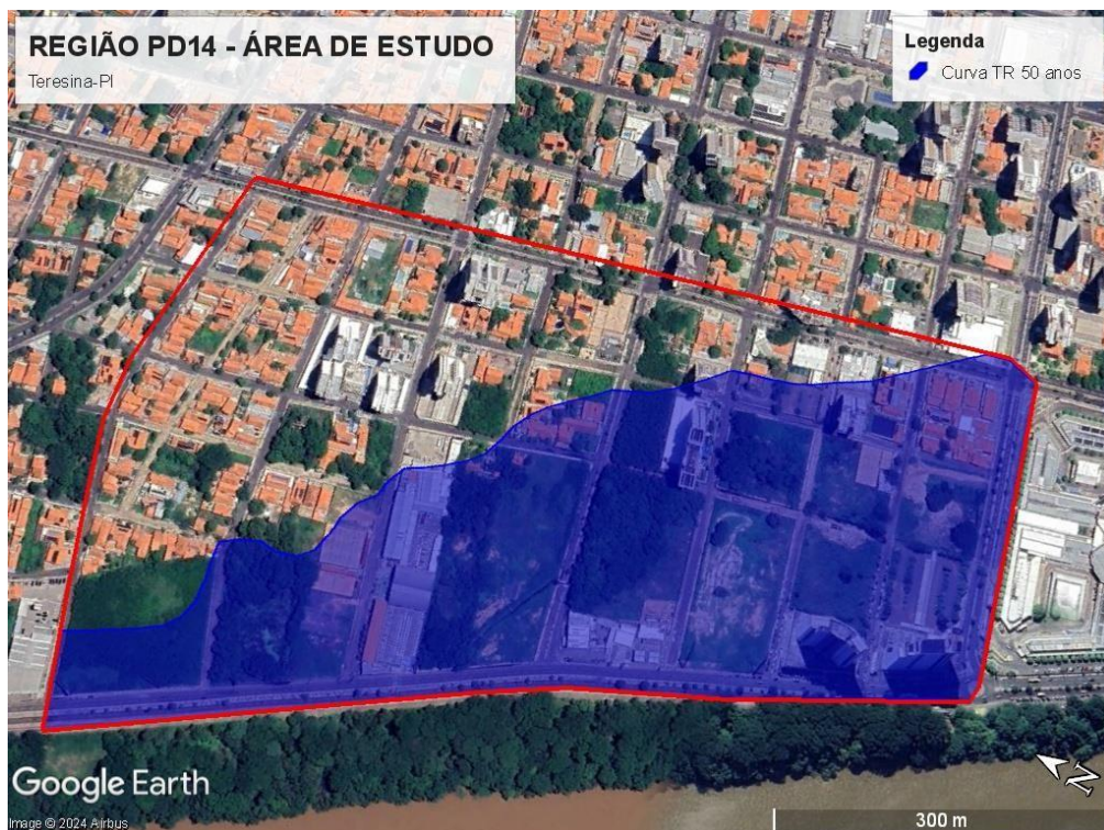
Figura 51 - Mancha de inundação - Tr = 50 anos
