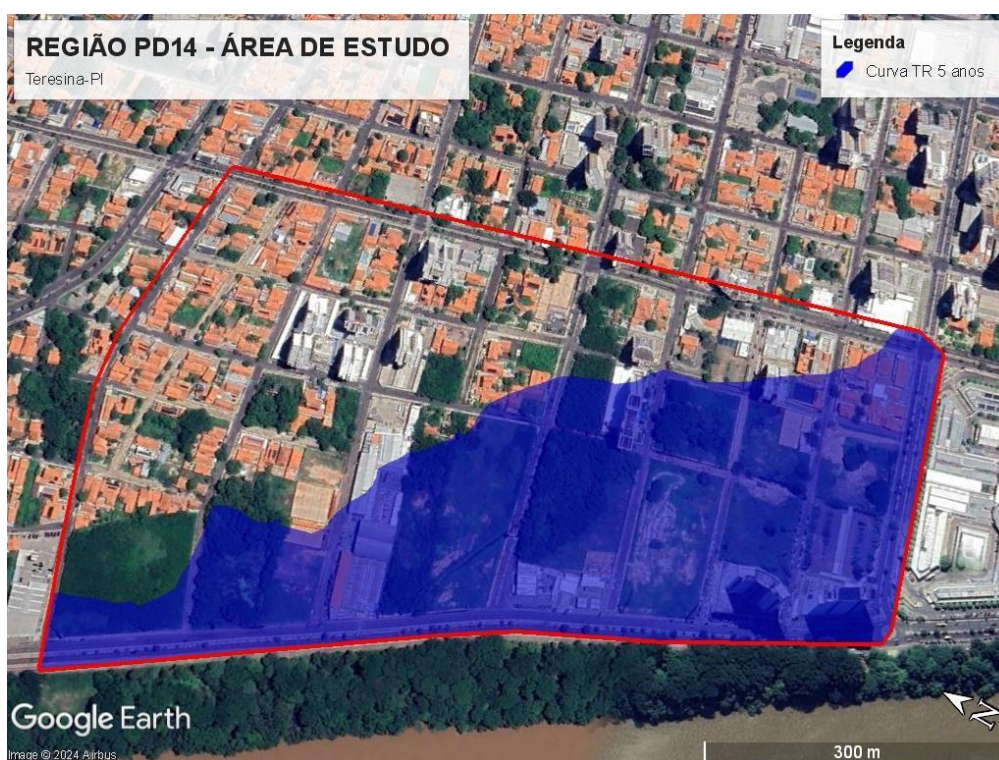
Figura 39 - Mancha de inundação - Tr = 5 anos
