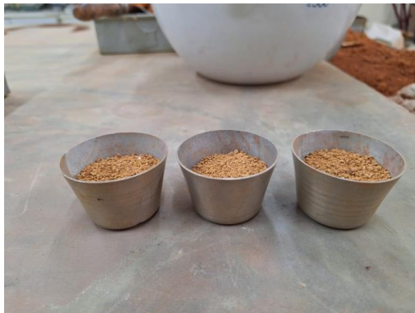
Figura 12 - Amostras de solo para ensaio do teor umidade
