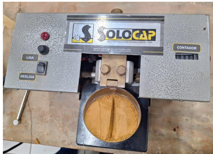
Figura 14 - Aparelho Casagrande preenchido com amostra do solo
