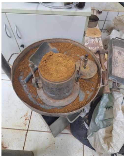
Figura 23 - Moldagem do corpo cilíndrico
