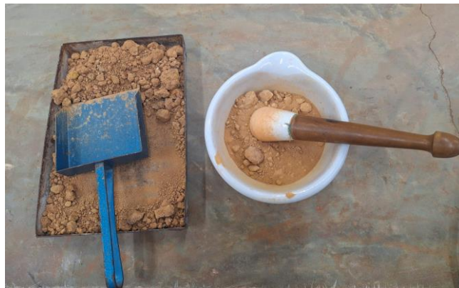
Figura 16 - Destorroamento do material
