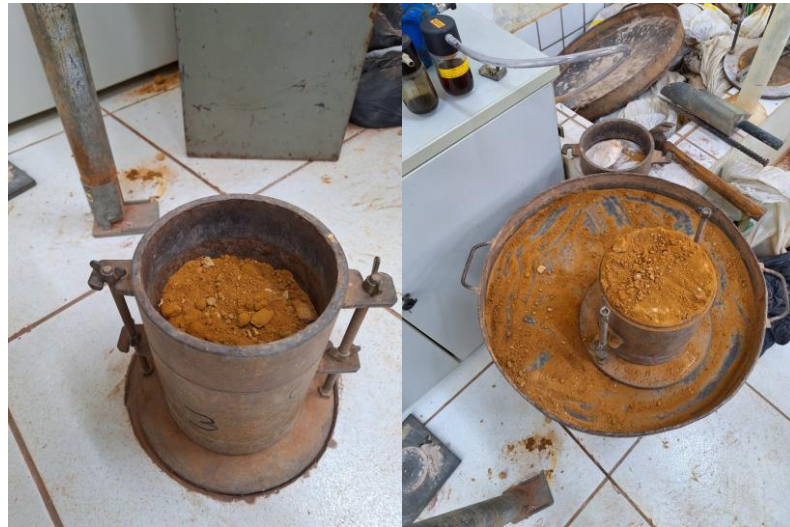
Figura 22 - Moldagem do corpo cilíndrico
