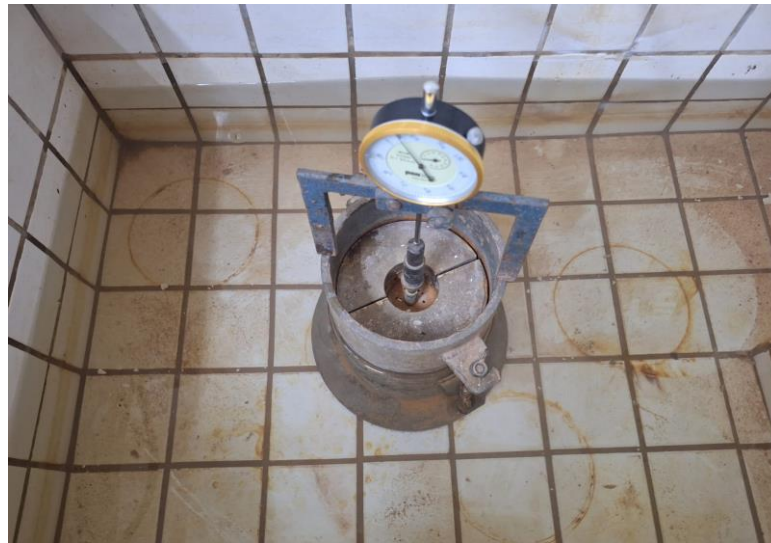
Figura 24 - Imersão do corpo cilíndrico
