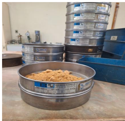
Figura 17 - Passagem na peneira de 0,42 mm
