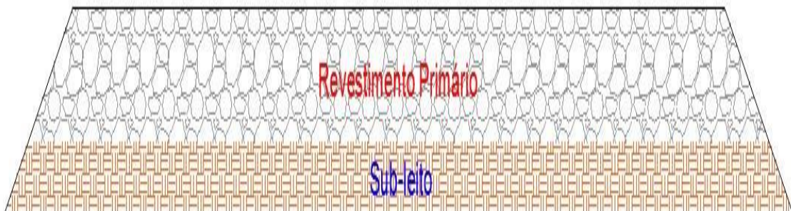
Figura 4 - Seção transversal de uma estrada rodoviária com revestimento primário
