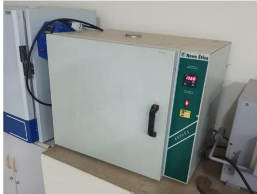
Figura 13 - Estufa para realização da secagem do material, modelo 410/3ND
