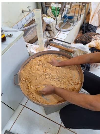
Figura 21 - Preparação da amostra para compactação
