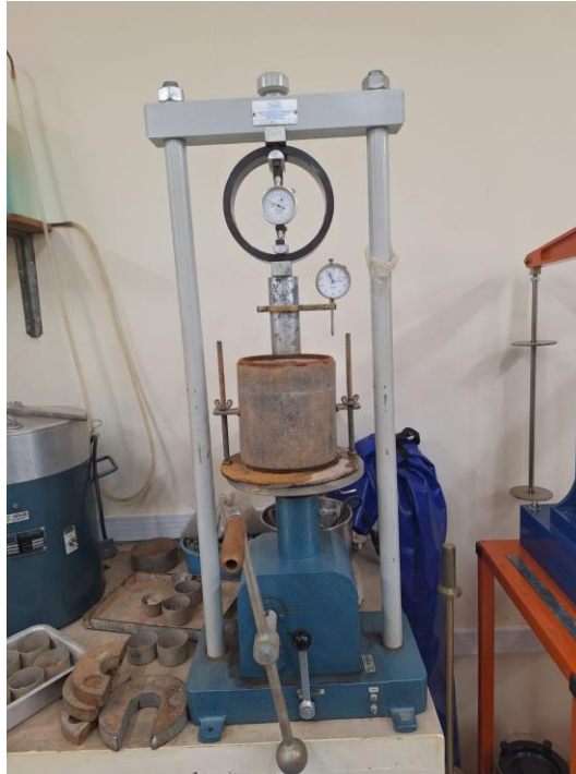
Figura 26 - Corpo cilíndrico na prensa
