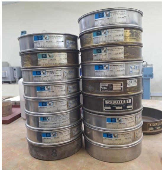
Figura 20 - Peneiras utilizadas para análise granulométrica
