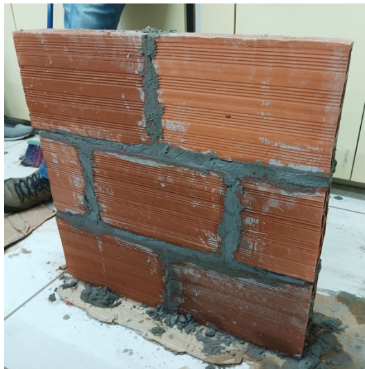
Figura 10 - Protótipo construído com bloco de cerâmica.
