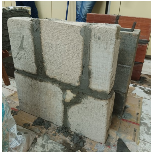
Figura 9 - Protótipo construído com bloco de concreto celular.
