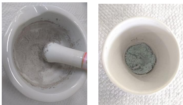
Figura 24 – Cinza com NaOH: a) antes da fusão alcalina (mistura da cinza com NaOH) e b) após a fusão alcalina.
