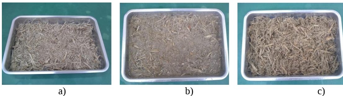
Figura 15 – Processo de limpeza do BCA por decantação: a) deposição em recipiente, b) imersão em água, agitação e repouso e c) peneiramento, lavagem e deposição em recipiente.
