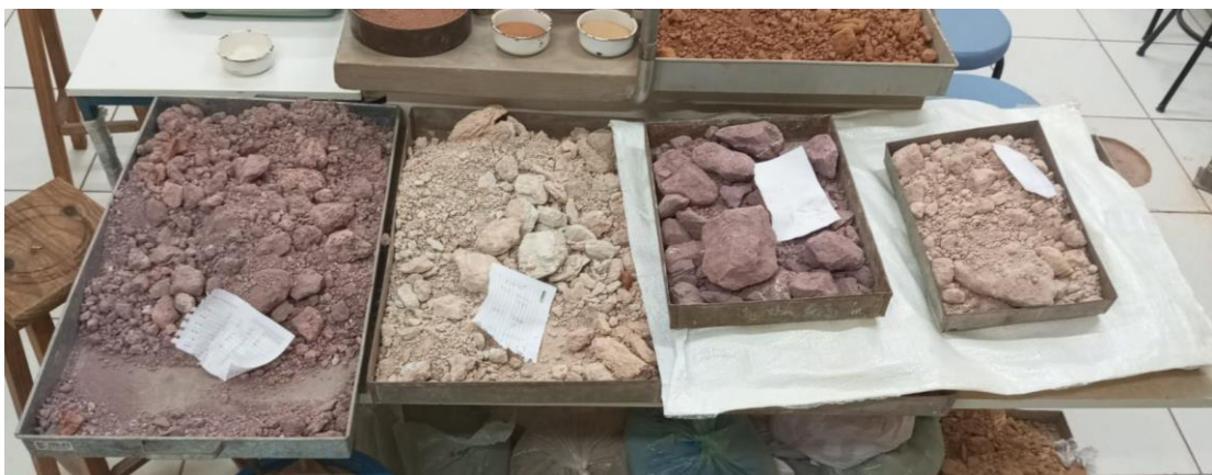
Figura 23 – Visão geral do material das quatro camadas coletadas do talude.
