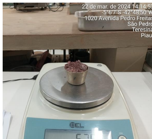
Figura 25 – Pesagem da amostra após secagem.
