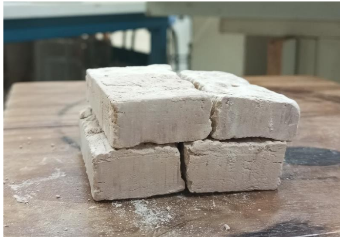
Figura 34 – Amostra rompida após ensaio de cisalhamento.
