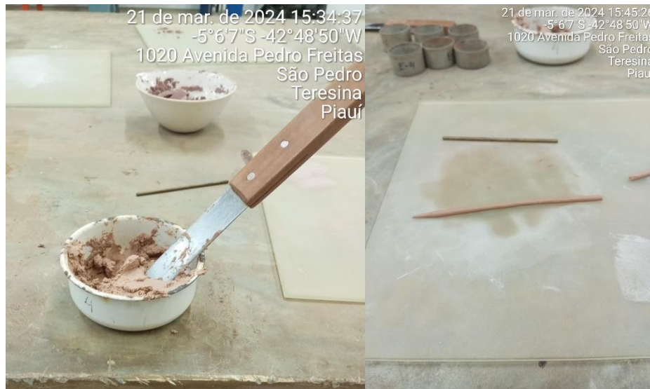
Figura 30 – Procedimentos do ensaio de plasticidade do solo.
