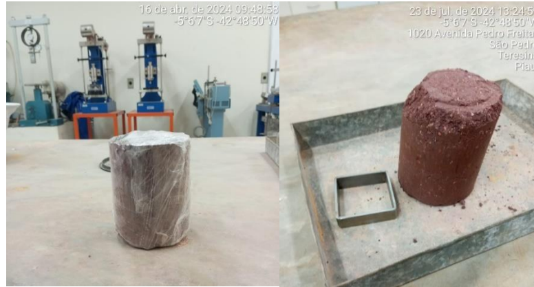
Figura 31 – Modelagem do corpo de prova de cisalhamento direto.
