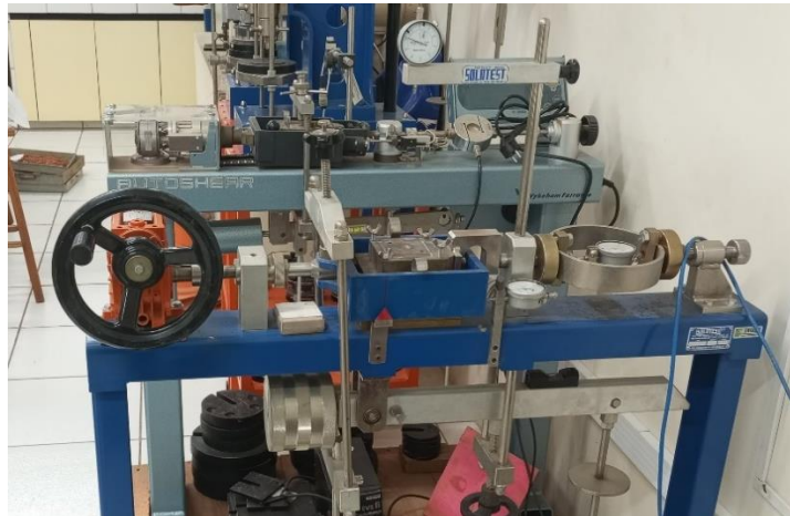
Figura 32 – Máquina manual de cisalhamento direto.
