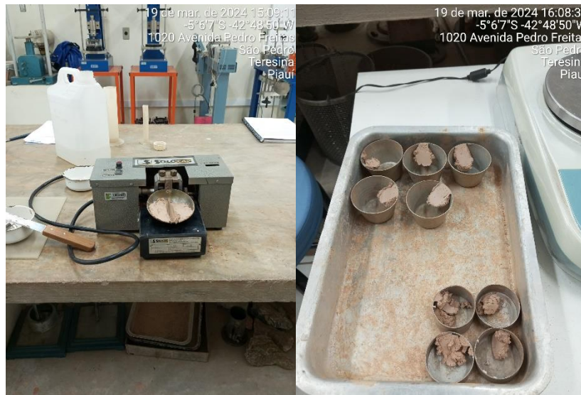
Figura 29 – Procedimentos do ensaio de liquidez do solo.
