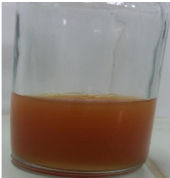
Figura 8: Amostra de análise de cloretos depois da titulação.
