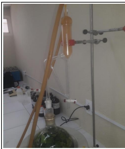
Figura 6 – Extração do OE de C. Sinensis por hidrodestilação com aparelho tipo Clevenger
