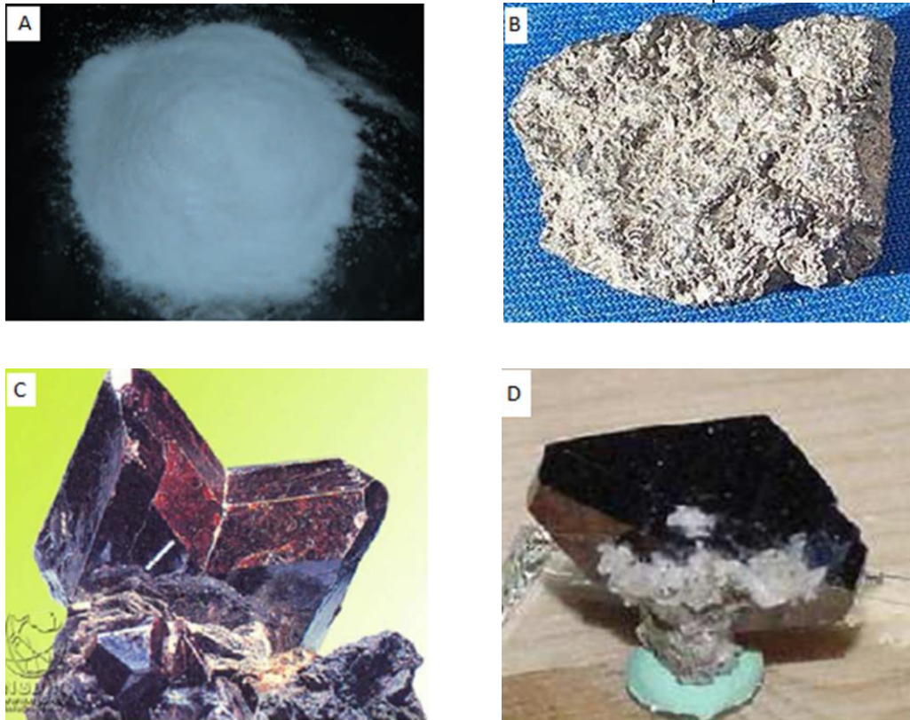
Figura 1.7 - Imagens mostrando a forma dos minerais de ilmenita ( \text{FeTiO}_3 ) B, rutilo em C e anatase D. em A o dióxido de titânio na forma pura.
