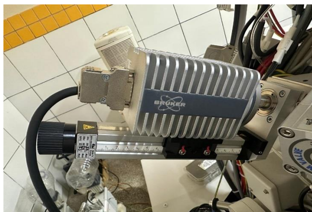
Figura 12 - Espectroscopia de dispersão de energia (EDS)
