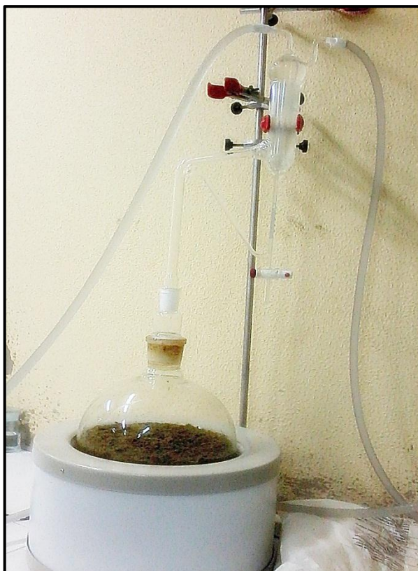
Figura 04 - Aparelhagem utilizada no método de hidrodestilação
