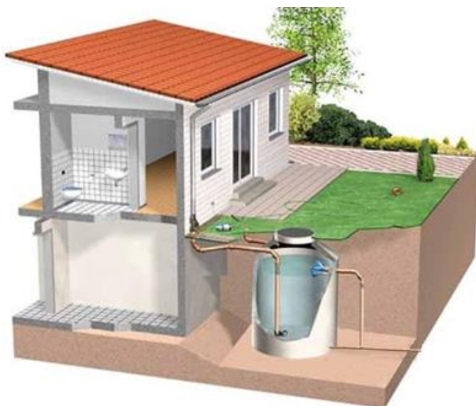
Figura 7 – Croqui de microrreservatório enterrado
