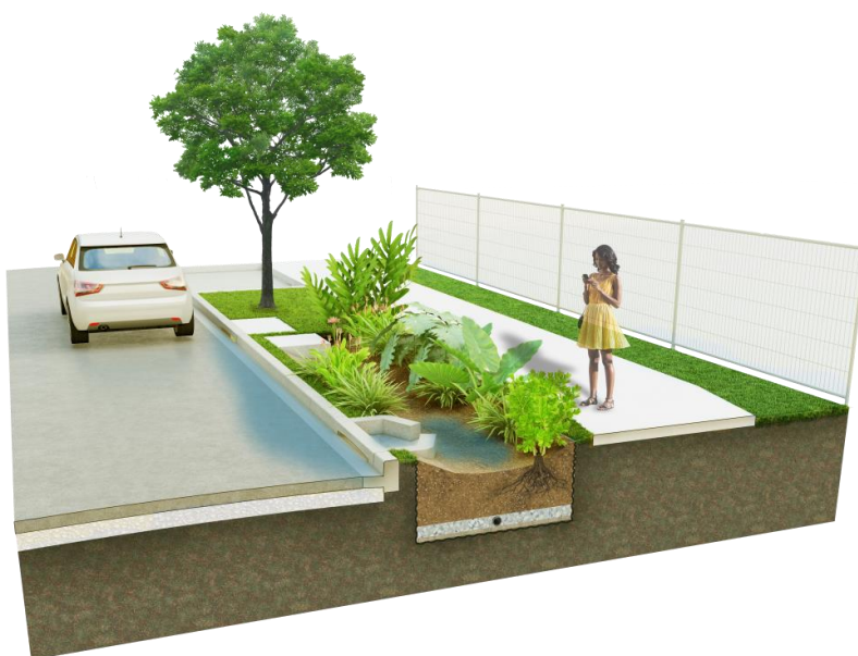
Figura 5 - Corte esquemático de jardim de chuva
