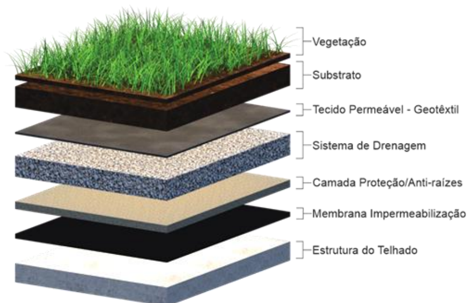
Figura 3 – Camadas do telhado verde
