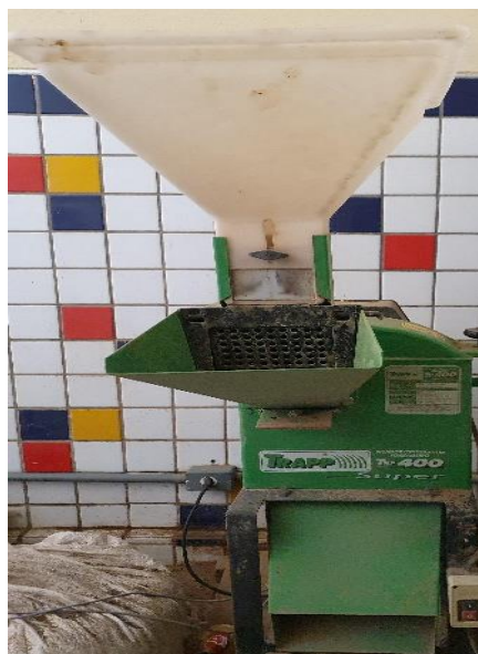
Figura 8 - Equipamento destorroador de material.
