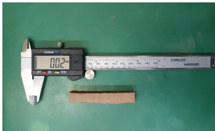
Figura 19. Paquímetro com corpo de prova seco
