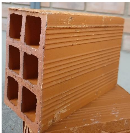
Figura 1. Bloco de vedação de seis furos.
