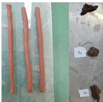
Figura 16. Amostras do ensaio antes e após para água de esfarelamento.
