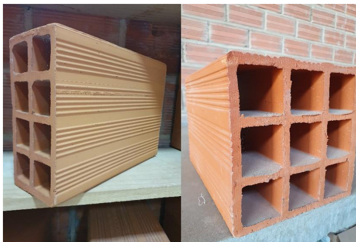
Figura 2. Bloco de vedação de oito e nove furos, respectivamente.
