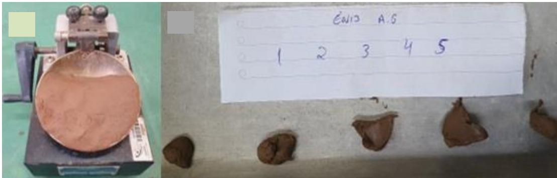
Figura 17. Aparelho de Casagrande com argila e amostra da ranhura.
