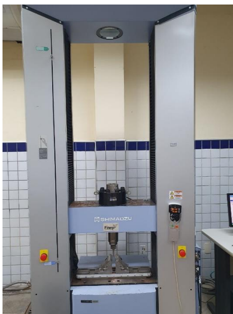
Figura 20. Máquina universal de ensaio de resistência.
