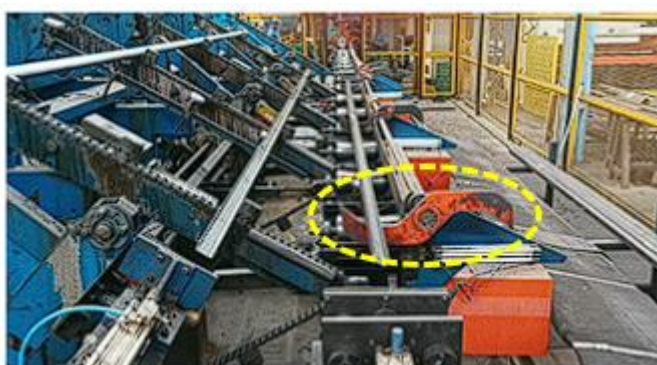
Figura 5 - Garra para remoção de produto não conforme.
