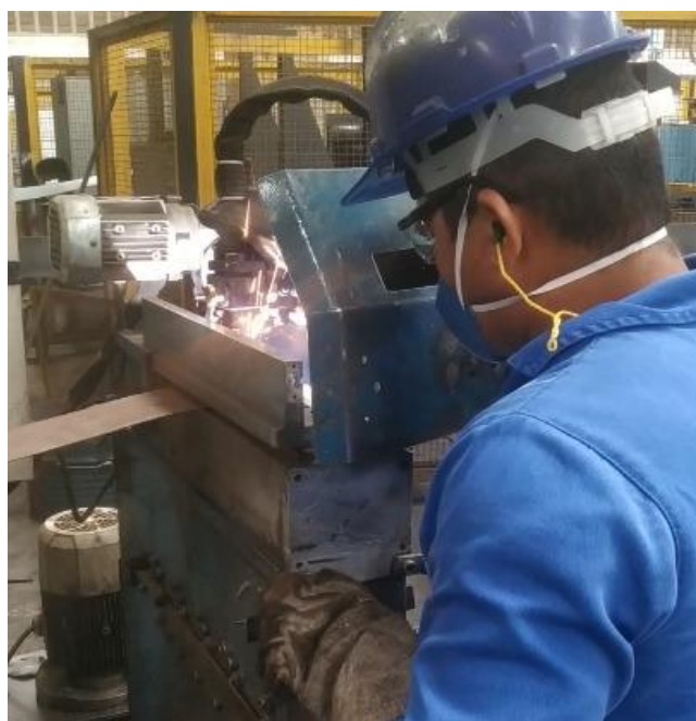
Figura 1 - Solda para reabastecimento.
